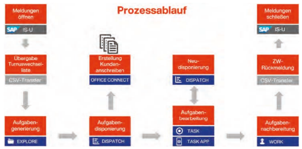
Bild: Prozessablauf beim Zählerwechsel mit Lovion in Verbindung mit SAP IS-U
